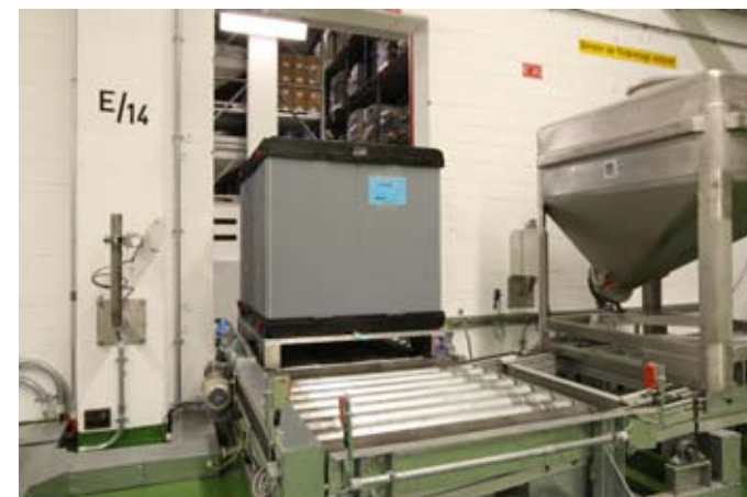
RFID-Gate an der Fördertechnik mit Richtungserkennung
