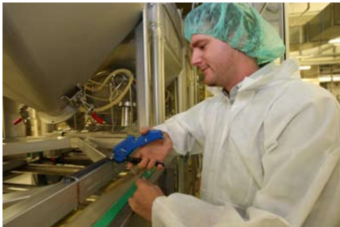
Montage des Transponders am Behälter
